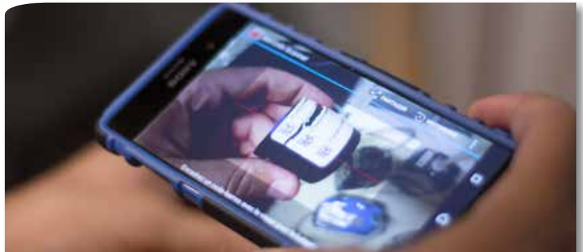
Enregistrer toutes les informations pour le rapport de prélèvement. Chaque cassette de prélèvement utilisée est répertoriée ; la traçabilité de l'ensemble des conditions de prélèvement est importante. Elles seront portées dans le rapport de prélèvement. 7
