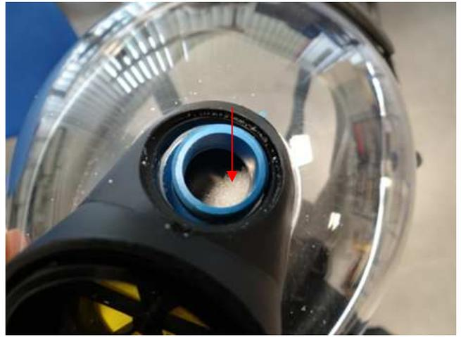
**Figure 4 : Particules accumulées sur la membrane phonique (vue après démontage de la grille de protection externe)**
